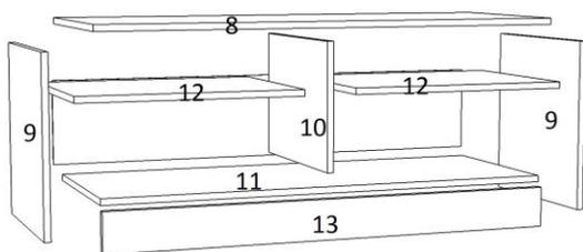
К боковине 9 прибить гвоздями опоры. К боковинам 9,10 привернуть шурупами 3,5\*16 направляющие колесом вперед. С помощью еврошуруров и двухсторонних эксцентриков привернуть вязки 11,12 и цоколь 13 к боковинам 9 и 10. Ввернуть эксцентрики в крышку 8 и установить на собранную конструкцию. Прибить гвоздями заднюю стенку ДВП 10, предварительно измерив диагонали.
