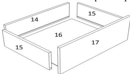
Еврошурупам скрутить боковины 15 и деталь 14. В пропилил вставить ЛДВП и эксцентриками закрепить фасад. К нижней части ящика привернуть шурупам направляющими колесом назад.
