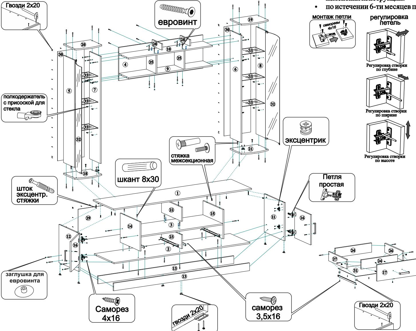
\*Гвозди 2x20 используются для крепления ДВП, саморезами 4x16 Крепятся петли.
